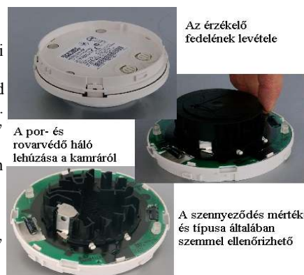
21.ábra: A 100/200 sorozatú érzékelők szétszedése
